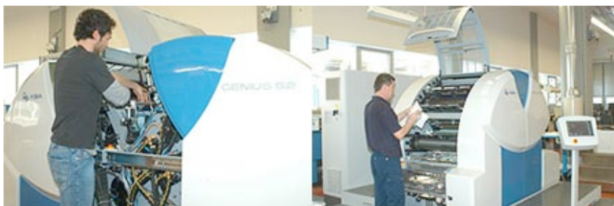
Der Drucker hat durch hochklappbare (rechts) bzw. seitlich verschiebbare Schutze (links) einen optimalen Zugang zu den Farb- und Druckwerken bei allen erforderlichen Bedien-, Reinigungs- und Wartungsarbeiten (6/7)
