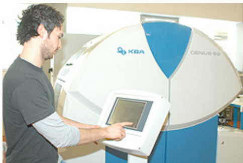
Durch die verschieb- und drehbare Bedienkonsole ist eine komfortable Maschinenbedienung an Anleger und Auslage gewährleistet (5)
