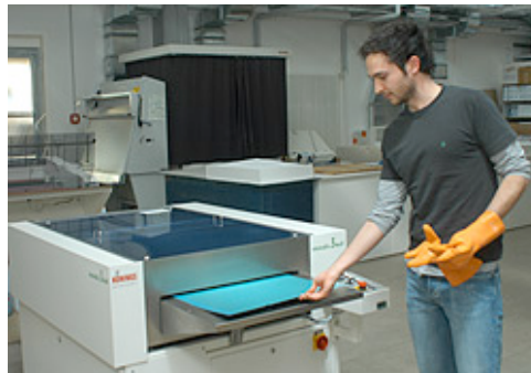
Entwicklung und Abkanten der wasserlosen Druckplatten (8)
